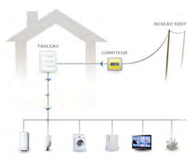
Installation électrique classique
