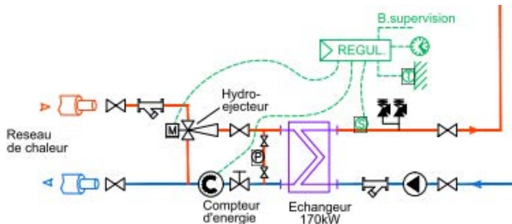
Double échangeur si production d'eau chaude sanitaire
