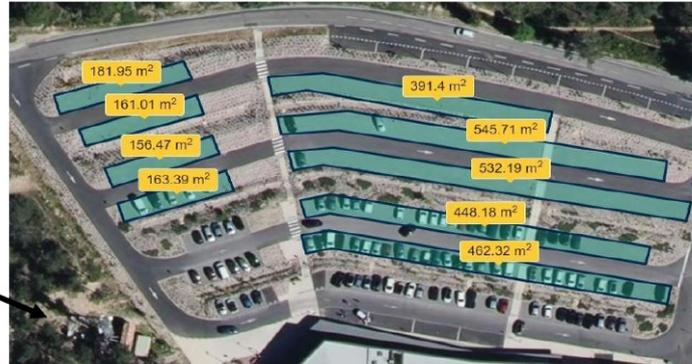
Figure 25 Vue aérienne du parking et surface exploitable, avec Antenne au coin inférieur gauche
